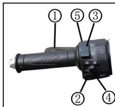
luces altas en el tablero; al presionar a la posición " " Se encienden las luces de cruce. Use luces de cruce al conducir en áreas urbanas o cuando se aproximen vehículos en sentido contrario para no deslumbrarlos.
