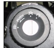
Posición "🔒": cuando la llave está en la posición de la marca "⊗", gire el manillar hacia la izquierda, presione la llave hacia abajo y al mismo tiempo gírela en sentido antihorario hasta la posición "🔒", el bloqueo de la dirección se extenderá y bloqueará el
